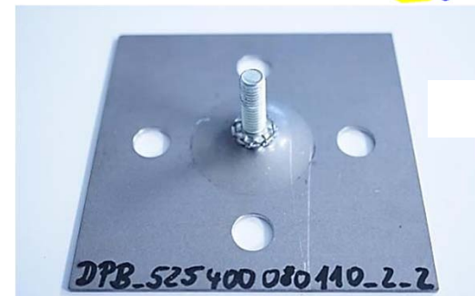
Funktionselement nach Durchzugversuch
