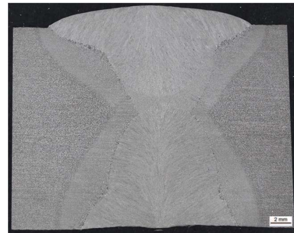
Makroschliff von Schweißnaht
