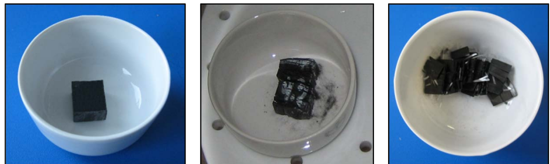
CFK-Probekörper vor, während und nach der thermischen Kalzinierung
