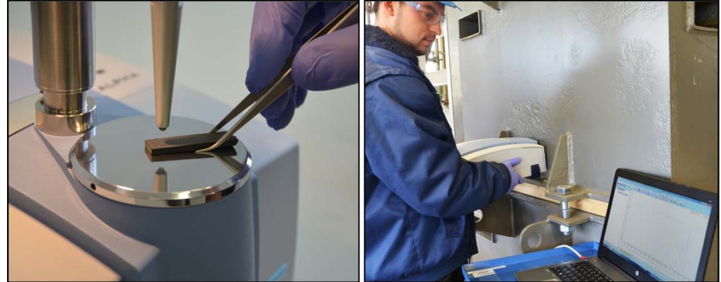
IR-Laboranalyse eines Feststoffes
