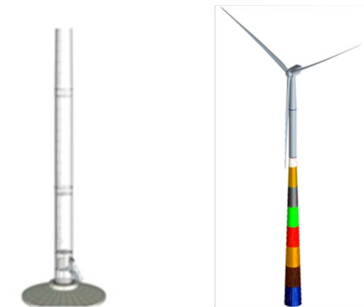
Alternative Segmentierung der unteren Turmelemente
