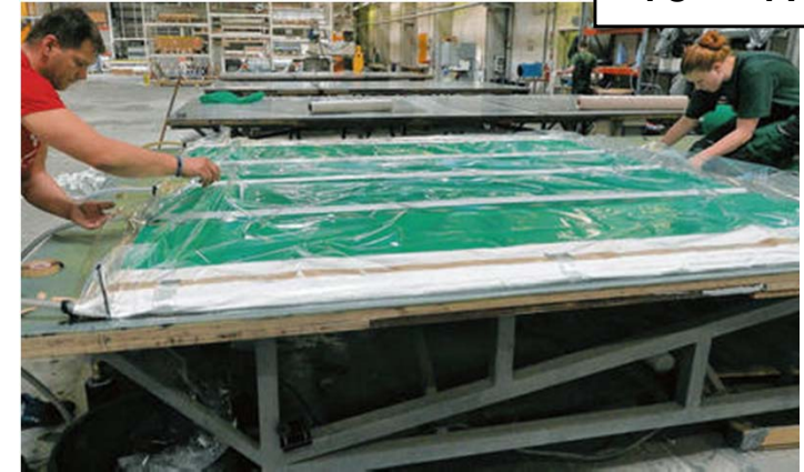
Derzeitige Fertigung von großflächigen, zweidimensionalen (ebenen) Bauteilen im Vakuuminfusionsverfahren bei der Fa. tfc - tools for composite
