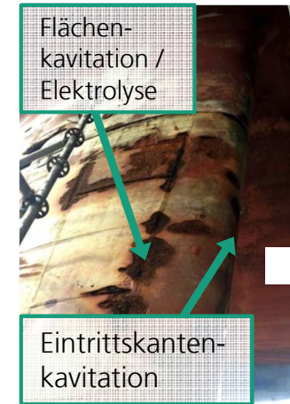
Erosive Schädigungen im Ruderbereich schnell fahrender Schiffe
