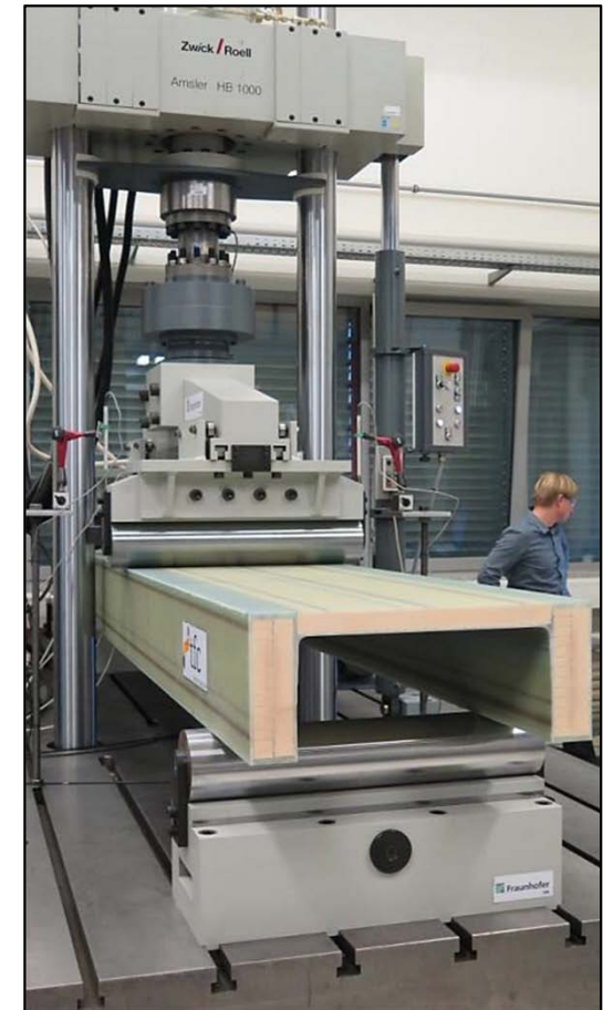
4-Punkt-Biegeversuch an einer GFK-Großstruktur
